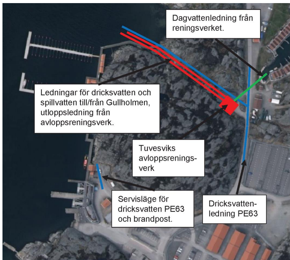
Befintliga VA-anläggningar i Tuvesvik, schematiskt ritade. Blått är dricksvatten, rött spillvatten och grönt dagvatten.
