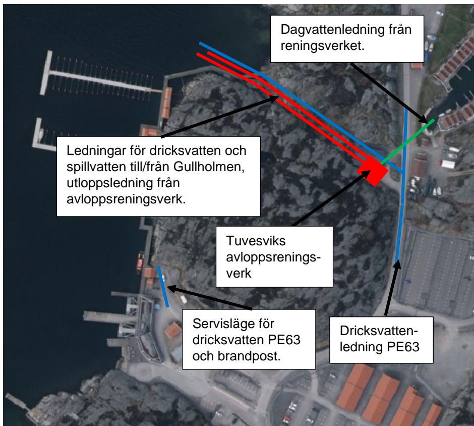
Figur 22. Schematisk presentation av befintliga VA-anläggningar i Tuvesvik. Blått markerar dricksvatten, rött spillvatten och grönt dagvatten.
