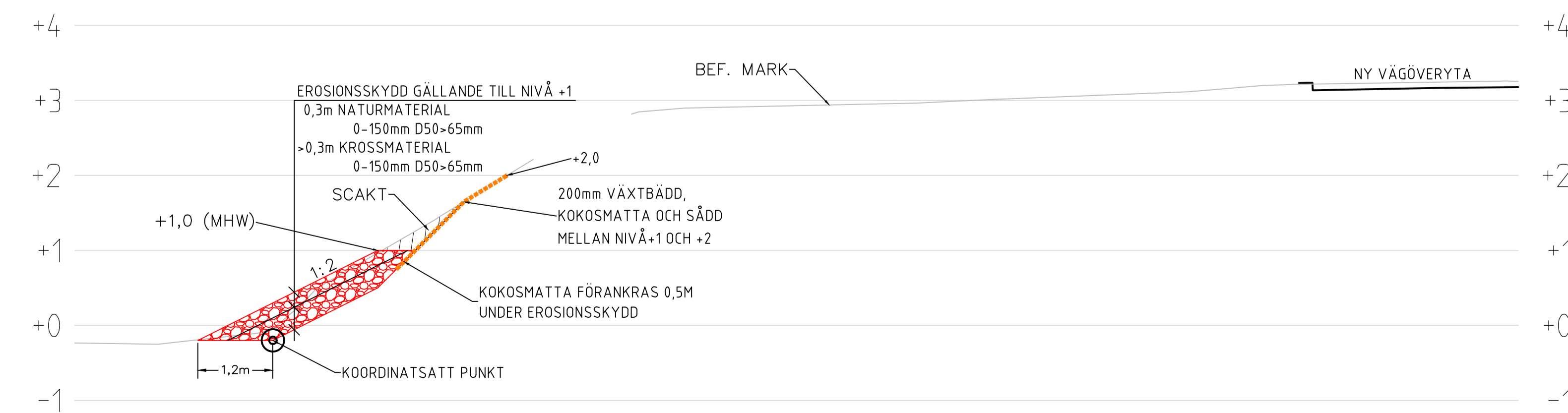
TYPSEKTION KM 0/150 - 0/210 SKALA 1:50
