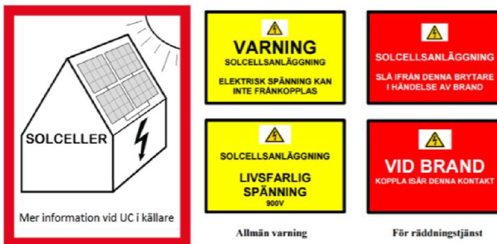
Figur 1. Exempel på skyltning av solcellsanläggning (SEK handbok 457)
