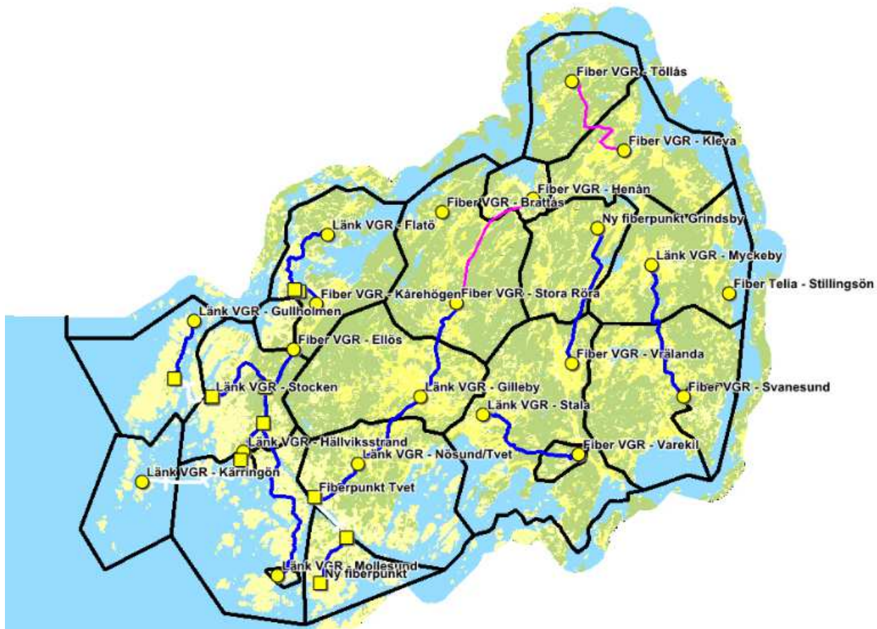
Figur 6. Föreslagna områdesindelningar, accesspunkter och fiberdragningar med stöd från kommun och ev. VGR.
