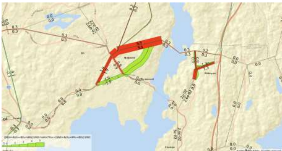
Figur 23. Skillnad i biltrafikflöden (tusental fordon ÅMD). 2040 UA2 minus 2040 UA1. I området kring Svanesund.
