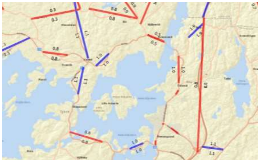
Figur 4. Förhållandet (kvoten) mellan modellberäknade biltrafikflöden och trafikräkningar årsmedeldygn 2014 efter kalibrering (ÅMD). I området kring Svanesund, Varekil och Tjörnbron.
